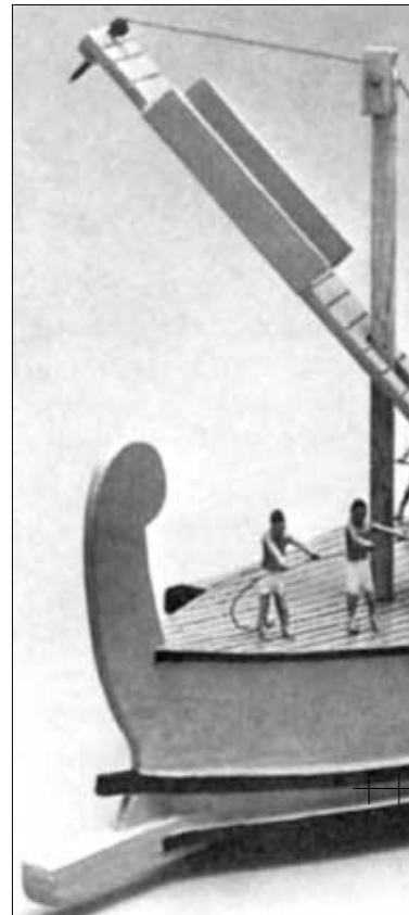
Við skipum av hesum slag vunu rómverjar sínar fyrstu sjóbardagar móti Karthago. Skipini høvdu, sum sæst, ein trant at høgga í figgindans før og eina landgongubrágv
