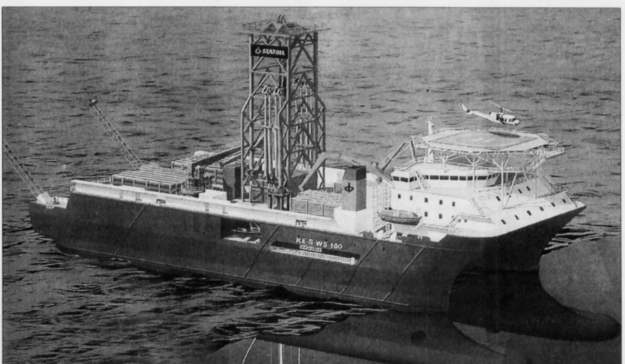
Hetta skipið skal koma í staðin fyrri boripallarnar. Tað kann nýtast eitt nú til royndarboringar við Føroyar niður til 1.500 metrar dýpið
