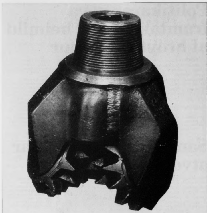
Oljuvinnan tekur seg fram hvønn einasta dag, og eins og við telduteknini, so mennist teknin innan oljuvinnuna eisini. Her er ein borarúna avmyndað. Tað er henda, sum líka frá tí oljuvinnu byrjaði, hefur bora seg niður íggjgnum fleiri túsund metrar av undirgrundini
