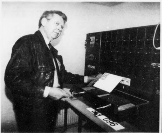
Atli Jensen, stjórn á Bileftirlitinum, við maskinuna, sum prentar nýggju nummarspjaldr- ini. Maskinan trýsir nummaríð inn á spjaldríð við eina megi uppá 50 tons. Mynd: Dám./Jens Kr. Vang
